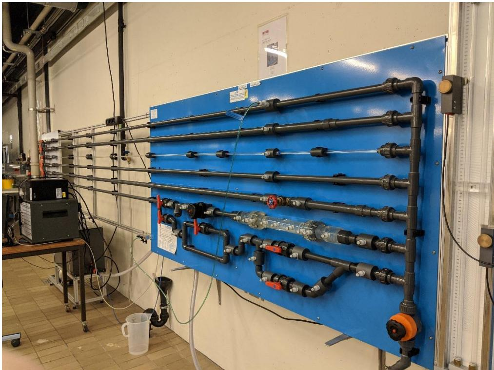
La mise en place est constituée de l'ensemble des tubes, des vannes et des joints ci-dessus.
